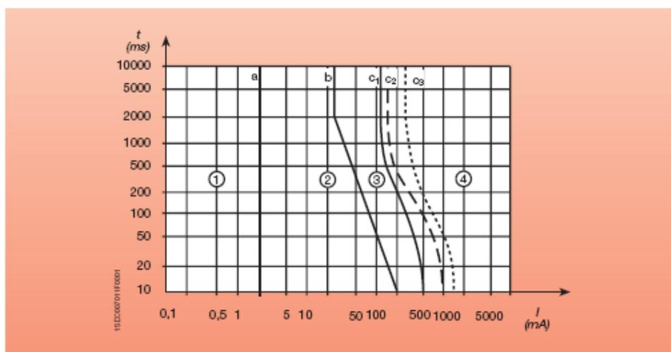
Figura 5.1 - Zone di pericolosità della corrente continua
